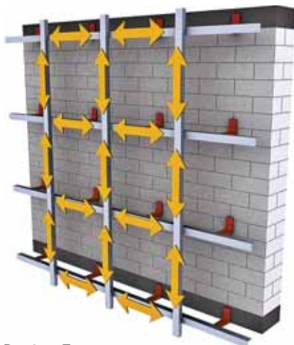
Рис.2а – Тепловые перемещения в системах NAVEK
