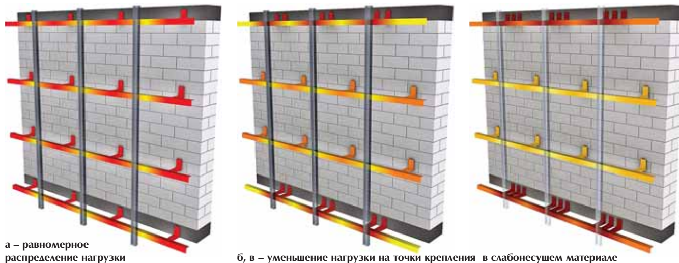
Рис. 4 – Три схемы крепления систем NAVEK в межэтажные перекрытия с различным распределением нагрузки:
